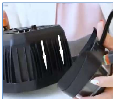
Collocare la freccia sul fanale, inserendo le viti della freccia nei fori corrispondenti sul fanale
