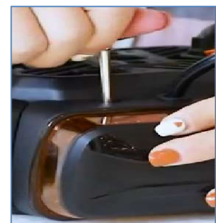
Avvitare e collegare il connettore della freccia con quello del fanale
